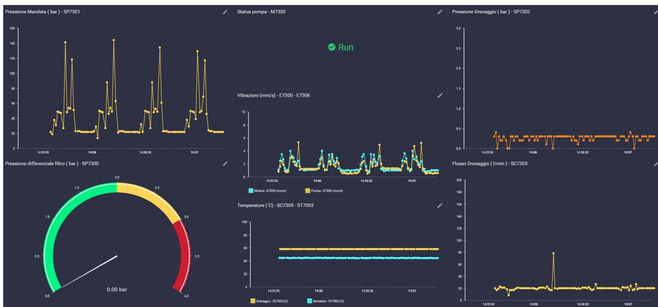
Anche per questo, la centrale oleodinamica in oggetto è stata dotata di un sistema di monitoraggio in cui tutti i trasduttori installati sui componenti sensibili sono gestiti da un software elaborato da Oleobi e visualizzabili su un portale dedicato.
